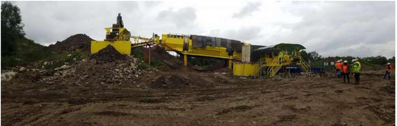
La problématique **amiante** a été prise en compte par la mise en place de systèmes de brumisation à toutes les étapes du tri. Les morceaux d'amiante-ciment sont pris en charge sur une table de tri par des opérateurs spécialisés et éliminés en filière agréée suivant le protocole réglementaire.
